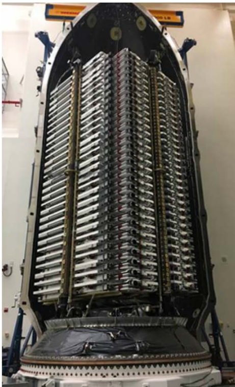
Abb. 2: SpaceX-Rakete Falcon 9 mit zwei Stapeln zu je 30 Starlink-Satelliten [2]
